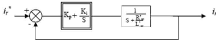
Figure III.24 : Schéma de régulation du courant de la partie série
