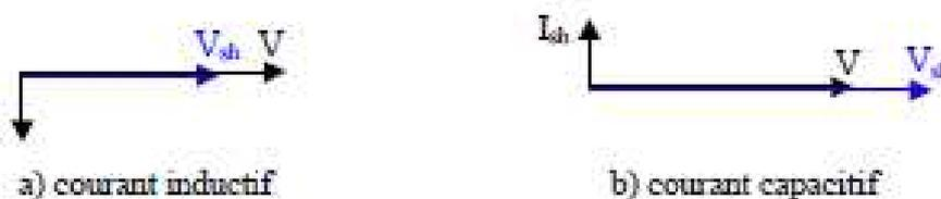
Figure II.4 : Diagramme vectoriel de STATCOM
