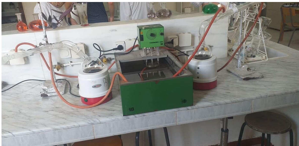
Figure 11: Extraction des huiles essentielles par hydro distillation (originale ,2021)
