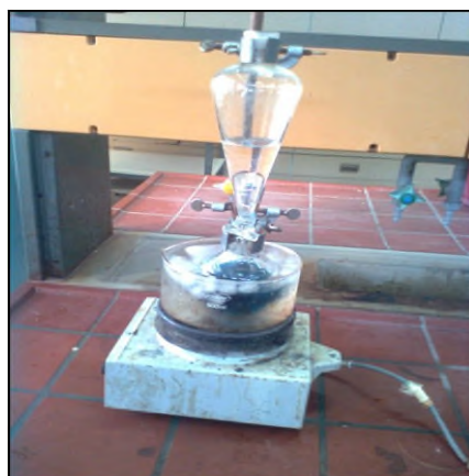
Figure II.1 : Le monomère utilisé dans la synthèse de la polyaniline : (a) : la formule de l'aniline ; (b) : montage de distillation du monomère
