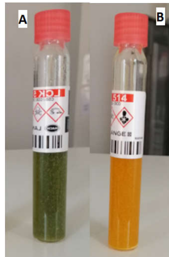
Figure 3 : Photo des kits LCK 515 + l'échantillon (boue) lors du dosage de la DCO avant (A) et après (B) la digestion anaérobie (Photo originale).
