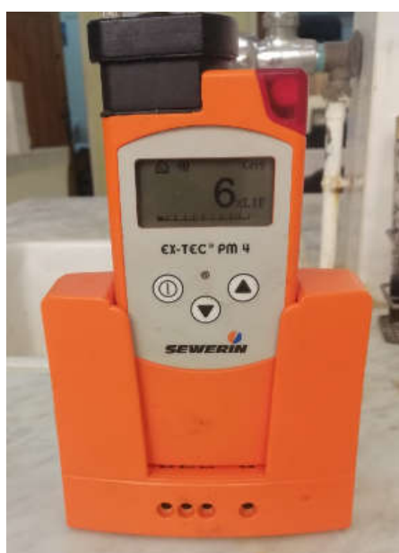
Figure 2 : Photo du détecteur de méthane EX-TEC PM4 SEWERIN (Photo originale).
