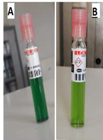
Figure 4 : Photo des kits LCK 340 + l'échantillon (boue) lors du dosage des nitrates avant (A) et après (B) la digestion anaérobie (Photo originale).
