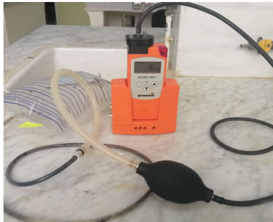
Figure 25 : Photo du détecteur de méthane EX-TEC PM4 SEWERIN relié à la poche du biogaz lors de l'essai de l'identification du biogaz. (Photo originale).
