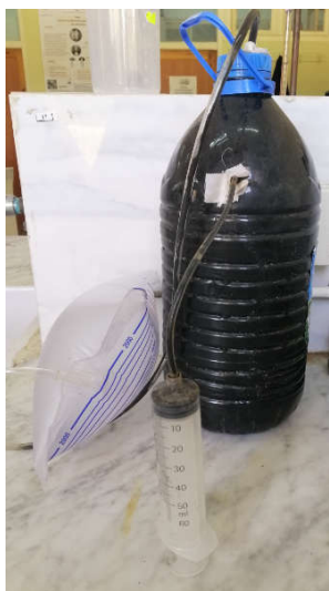
Figure 2 : Photo de la poche destinée à accueillir le biogaz (Photo originale).
