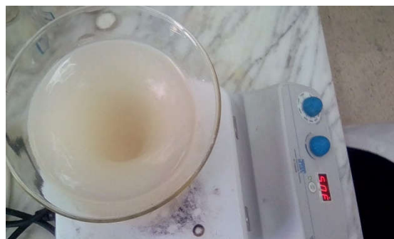
Figure IV.2 :Suspensions sur agitateur/plaque chauffante
