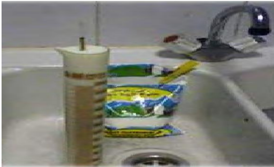
Figure 2 : Mesure de la densité par lactodensimètre
