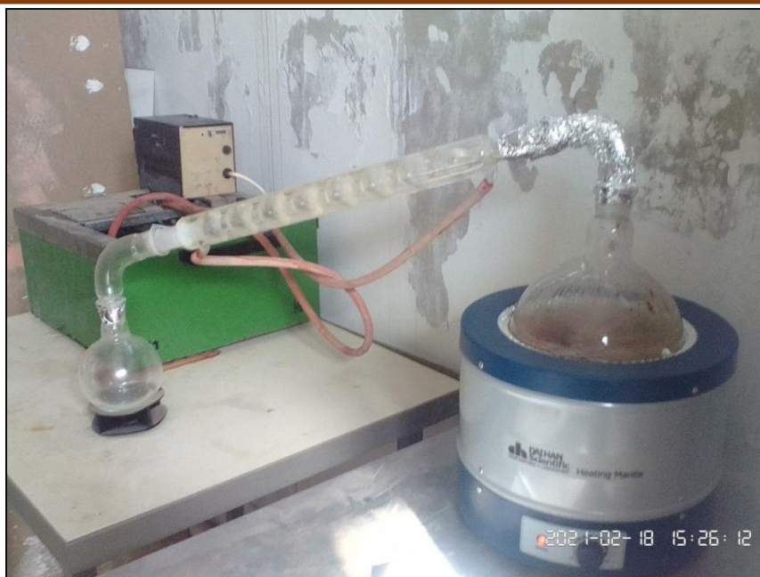
Figure N°09 : Montage de l'hydrodistillation au niveau du laboratoire (Cliché : KHENE. M, 2021).
