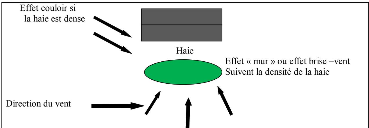
Figure9 : Effet d'une haie suivant la direction du vent
