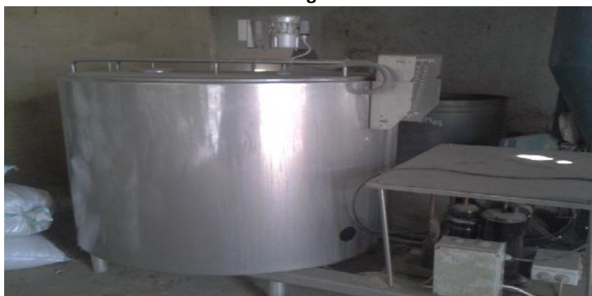
Cuve de stockage du lait EB
