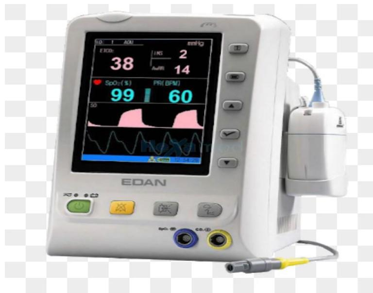
**Figure 22 : capnomètre/capnographie.**
