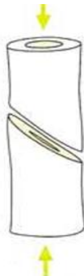
Figure N° 18: Fracture par compression (Roe, 1998).
