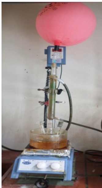
Figure.III.4. Montage de la polymérisation.
