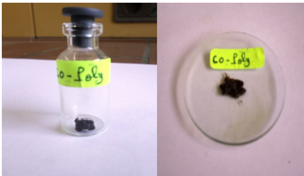
Figure.III.5. Représentation de l'aspect physique de co-polymère (méthacrylate de méthyle – chlorure de 3-(2-hydroxyethyl)-1-vinylimidazol-3-ium).
