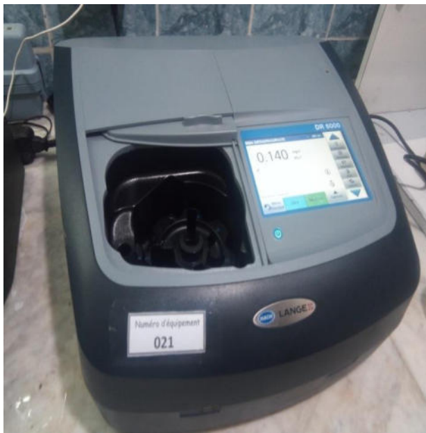
Détermination de Nitrate \text{NO}_3^- .
