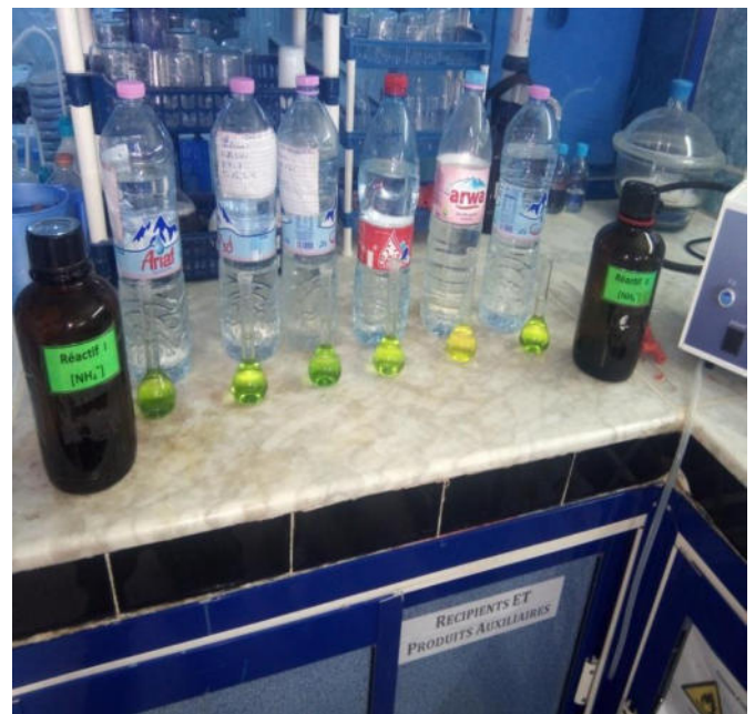
Détermination d'Ammonium \text{NH}_4^- .
