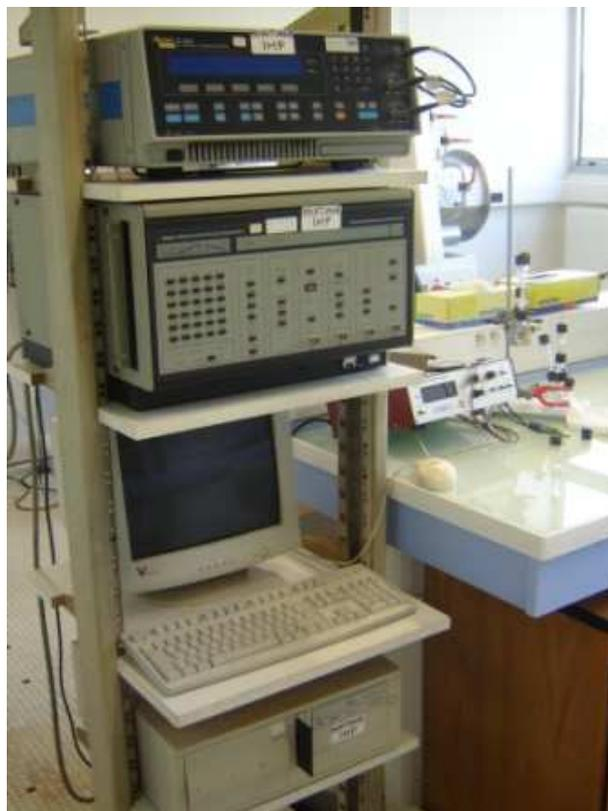
Figure III.2 : Analyseur d'impédance avec un four électrique.
