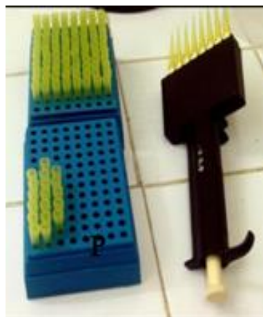
PHOTO 6: Micropipette de précision multicanaux et des embouts de pipettes à usage unique (à gauche) et micropipette de précision à un canal (à droite).
