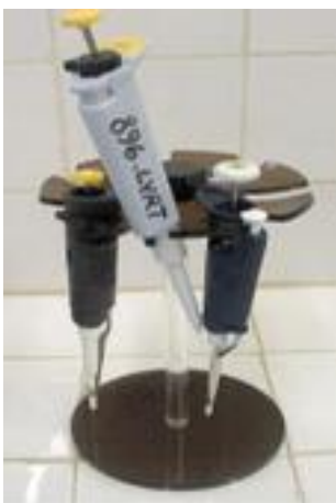
PHOTO 6: Micropipette de précision multicanaux et des embouts de pipettes à usage unique (à gauche) et micropipette de précision à un canal (à droite).
