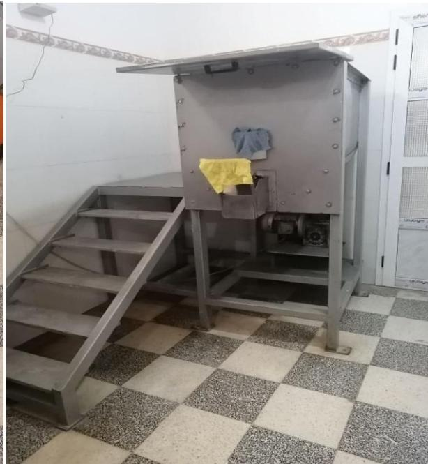
**Figure 24:** mélangeur en inox à double Hélice **Figure 25:** mélangeur en métal lourd à double hélice espacé
