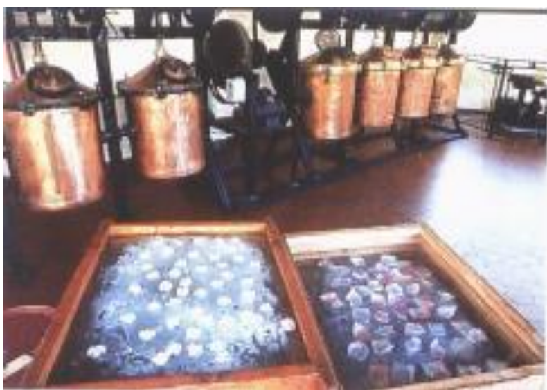
Figure 16 : Schéma du dispositif expérimental pour l'enfleurage à froid (Plaques de verre enduites de graisse)
