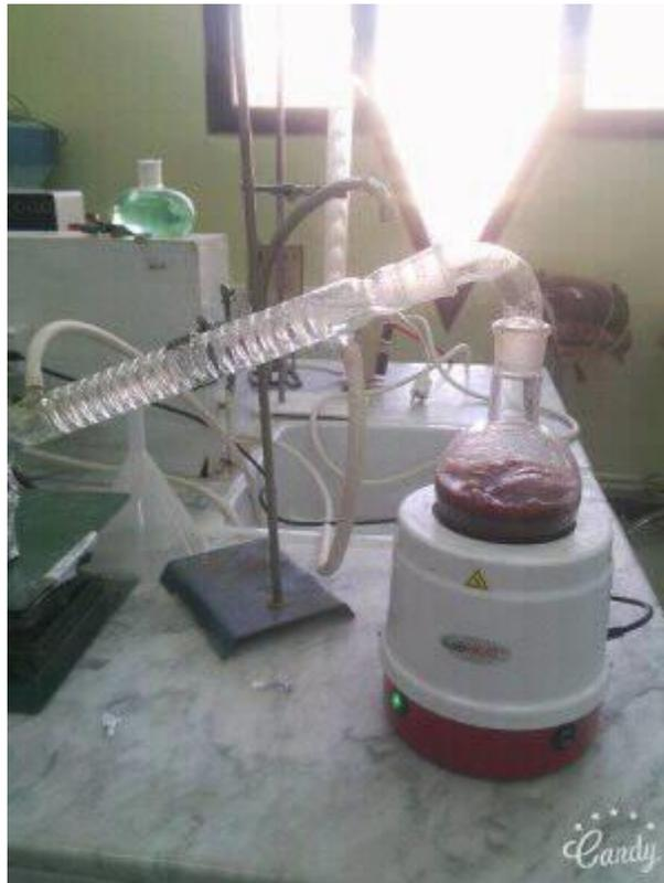
**Figure 2:** Dispositif d'hydro distillation
