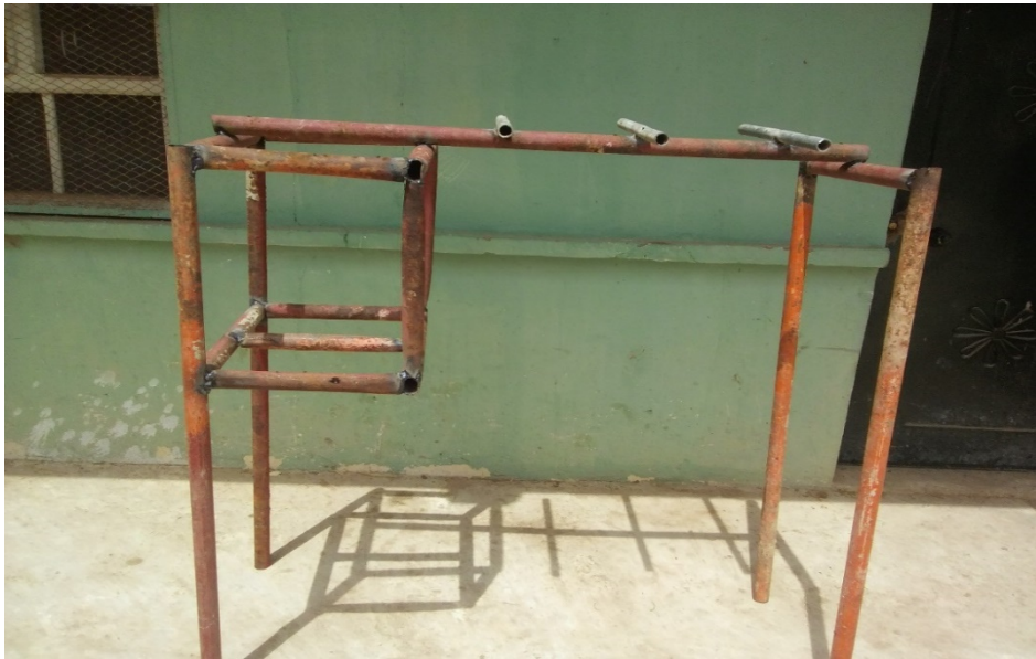
Figure 22 : le squelette du mannequin sur lequel en va poser un bassin osseux et un uterus fabriqué par une bache étanche
