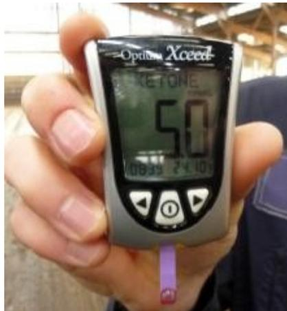
**Figure 22:** Appareil de mesure des corps cétoniques portable
