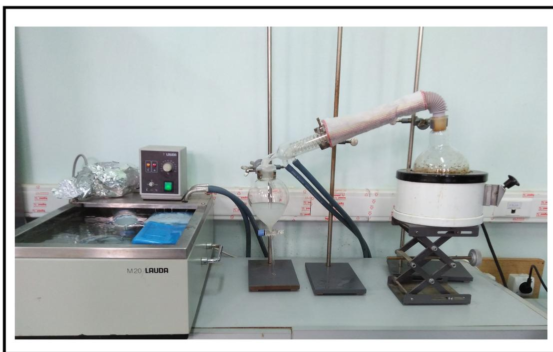
**Figure 2.2:** Dispositif d'hydro distillation
