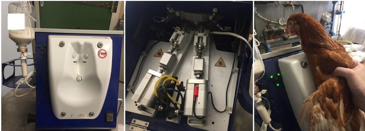
Figure 14 : De gauche à droite, un appareil pour vacciner, son système injecteur, le positionnement de la poulette (C. Misslin)
