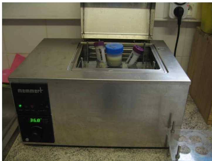
Figure 14 : cuve pour bain-marie contenant le milieu de dilution et les récipients allant accueillir le sperme, à température corporelle (36.8°C)
