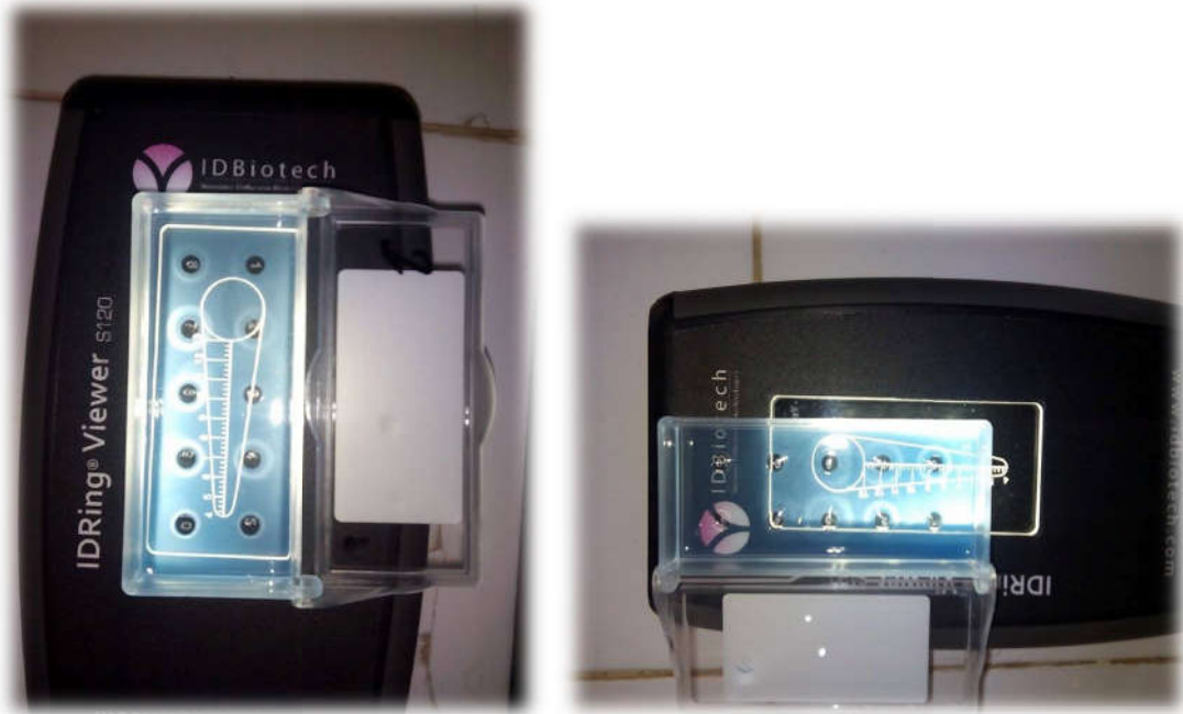
Figure 14: Lecture des plaques IDR par le lecteur IDRing Viewer
