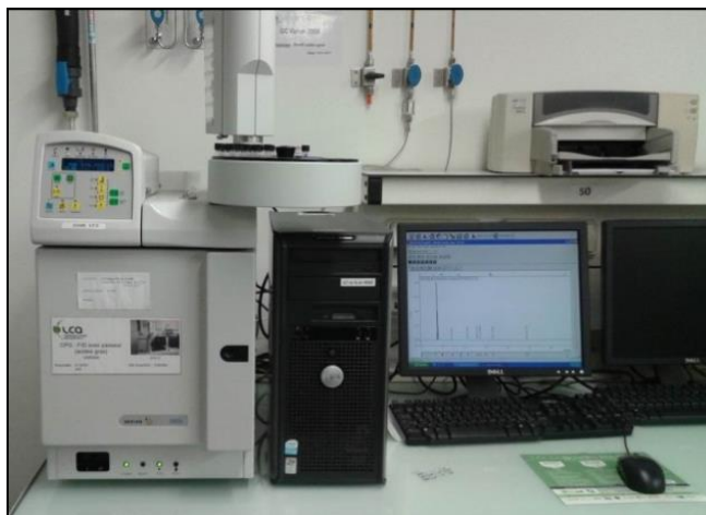
Figure 21: Le chromatographe en phase gazeuse VARIAN (3900).
