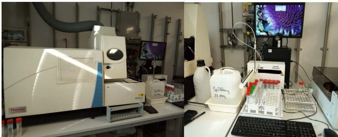
Figure 13 : Appareillage ICP-MS utilisé pour les analyses des métaux lourds (Cliché Naceur, 2018)
