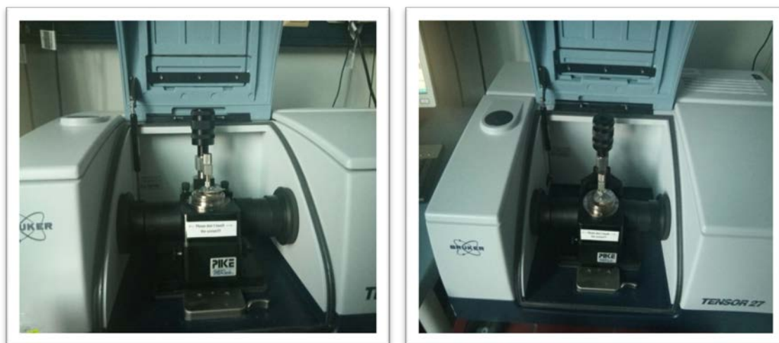
Figure 21 : Spectroscopie FTiR-ATR utilisé pour les analyses des composés inorganique (Cliché Naceur, 2018)
