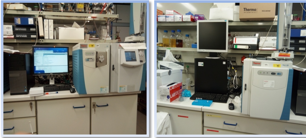
Figure 17 : Appareillage GC/MS utilisé pour les analyses (Cliché Naceur, 2018)
