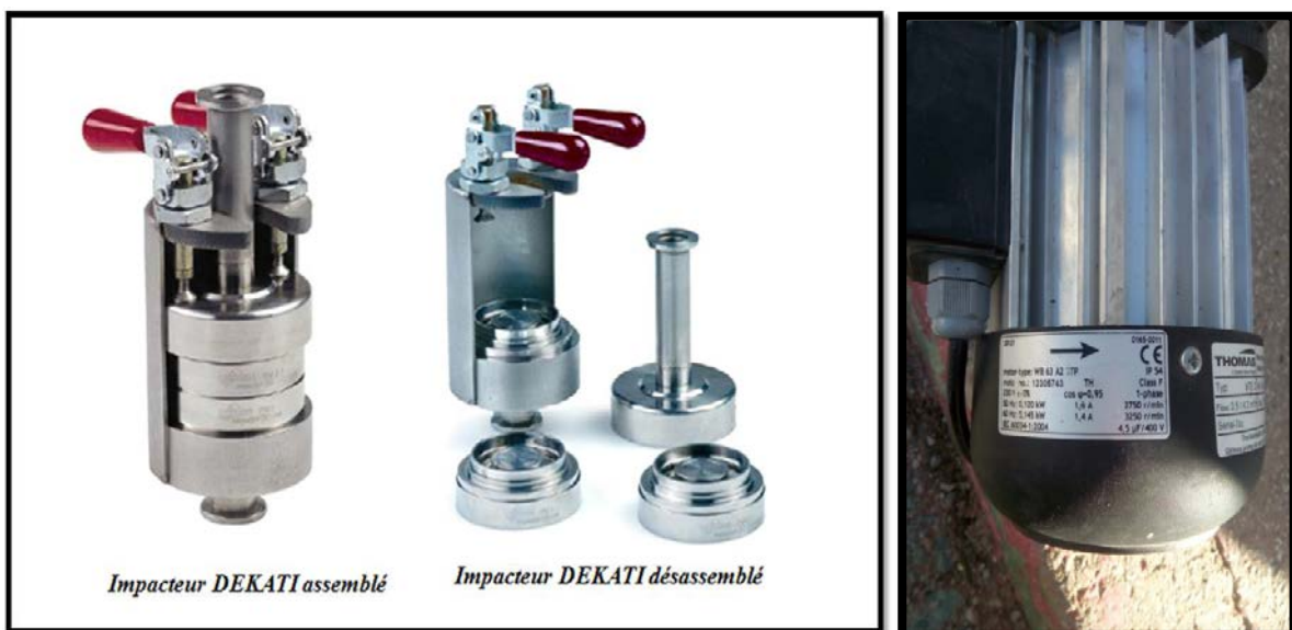
Figure 4 : l'appareillage de prélèvement « Impacteur DEKATI (Dekati Ltd, 2012) + pompe à pression (Cliché Naceur, 2017) ».
