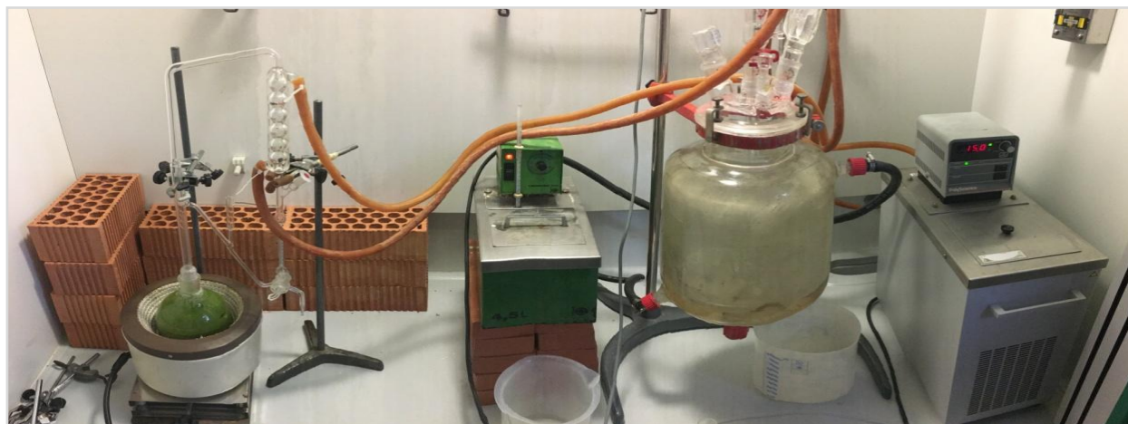
Fig.13. Extraction de l'huile des feuilles d' E. camaldulensis à l'aide d'un appareil de type Clevenger
