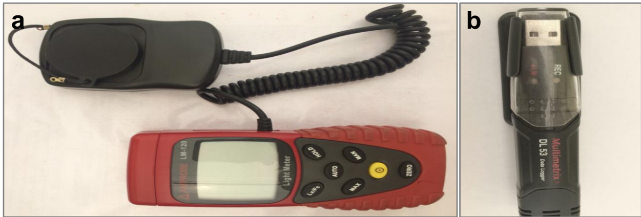
Fig.4. Appareils utilisés pour mesurer les paramètres climatiques et le flux lumineux (a: Luxmètre; b: Multimetrix)
