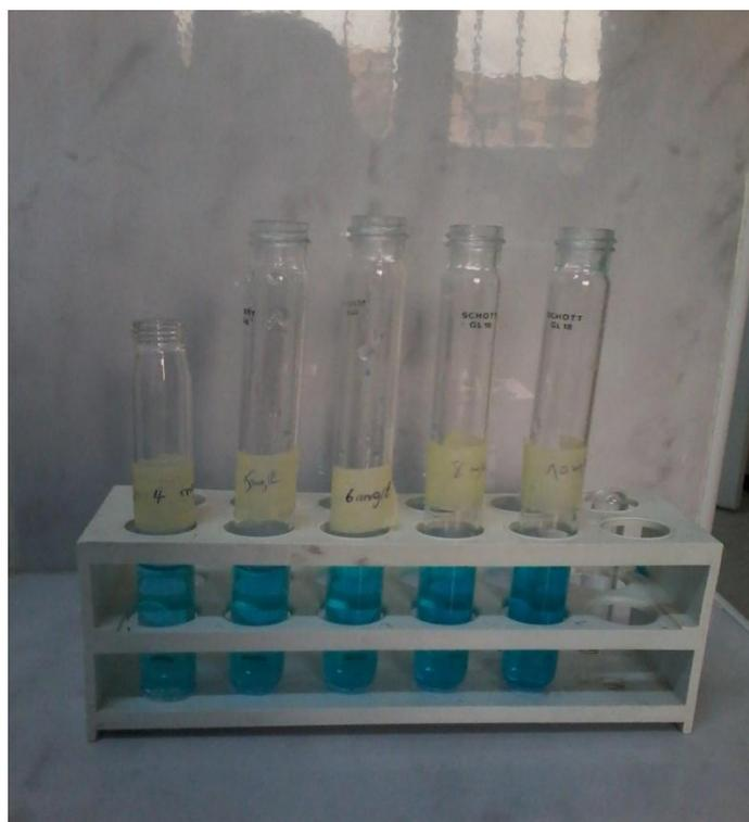
Les dilutions utilisées pour la courbe d'étalonnage
