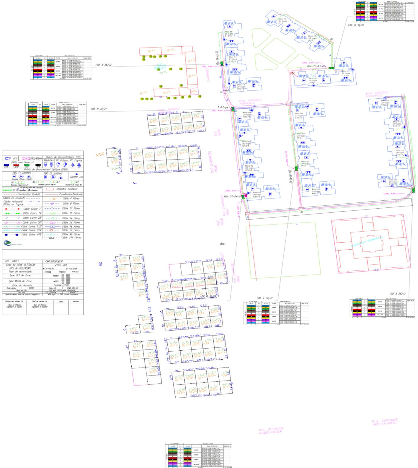
Figure 43: Le schéma final du déploiement du FTTH-GPON
