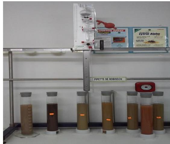
La mesure de la granulométrie à l'aide de la pipette de Robinson
