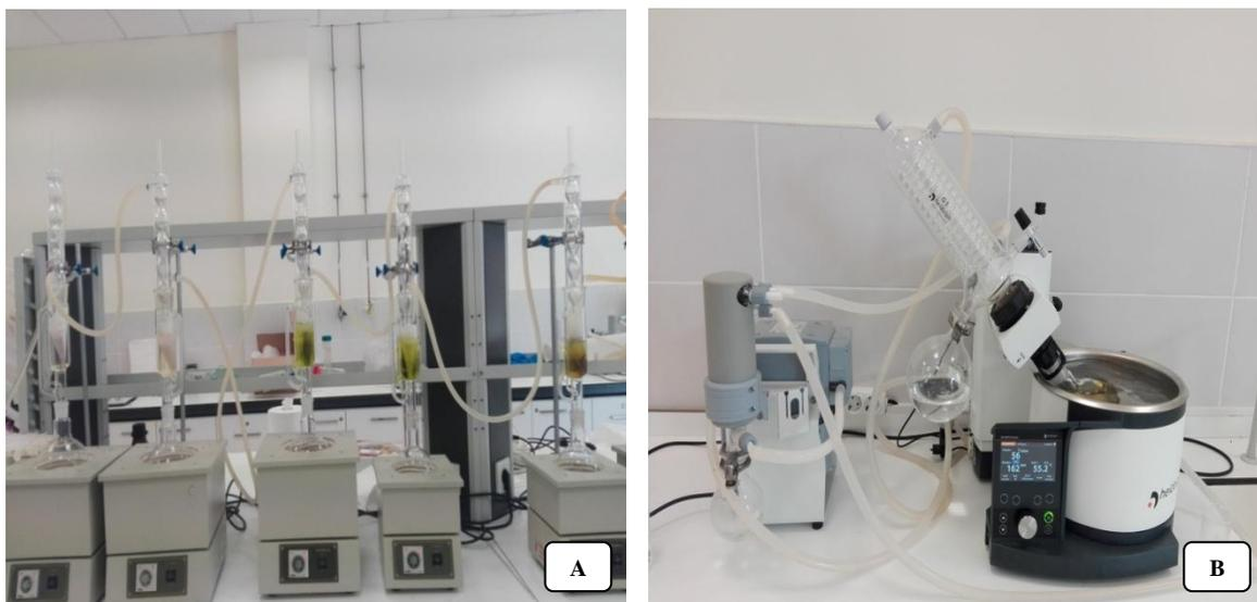
**Figure N°05:** (A) Extracteur Soxhlet (B) Récupération du solvant par le rotavapor.
