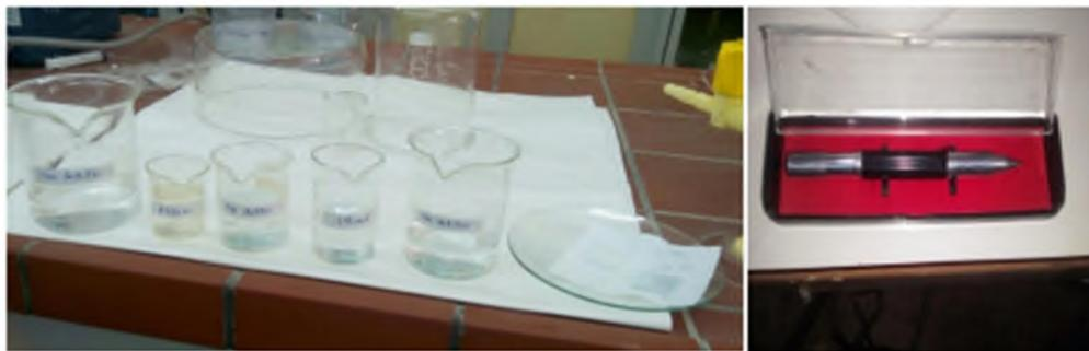
*Figure II.2: Photographie représentant la méthode de nettoyage des substrats et le stylo à pointe utilisée pour les découper.*
