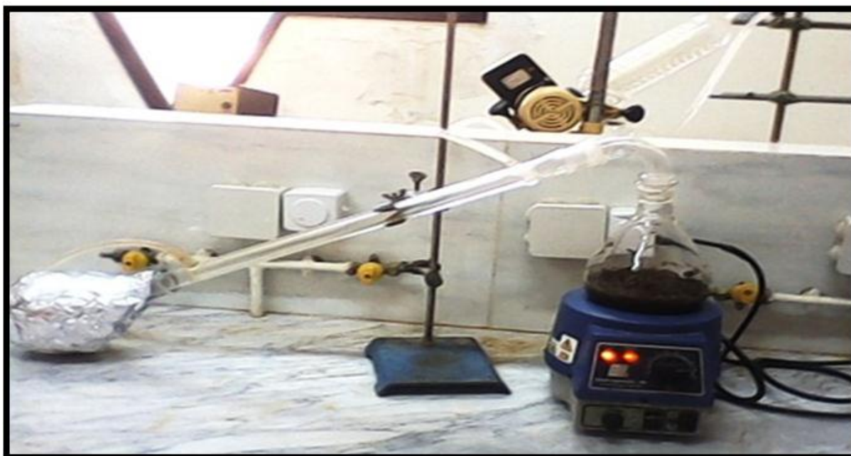
Fig.3 Montage d'hydro-distillation employé pour l'extraction d'huile essentielle.
