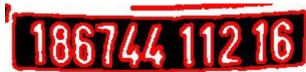
Figure 31: Détection de contour.
