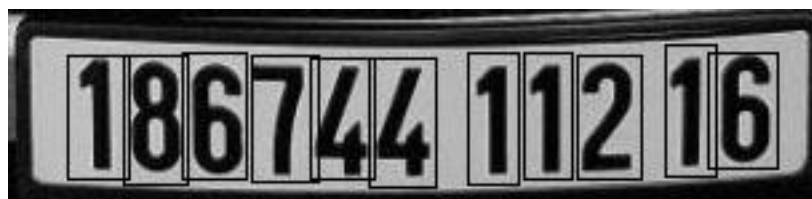
Figure 32 : Contours de forme rectangulaire.
