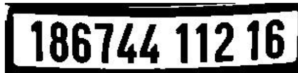
Figure 29 : La plaque en binaire.
