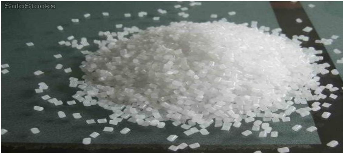
**Figure I. 63: Hips (Polystyrène résistant aux chocs) granulés [33].**
