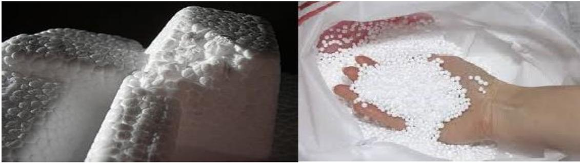
**Figure I. 74: Polystyrène expansé blanc destinées un matériau utilisé à la fois dans le bâtiment, l'agroalimentaire et la logistique.**
