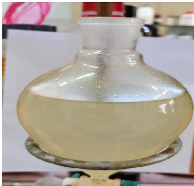
**Figure 6:** l'eau et l'huile dans l'ampoule à décanter.
