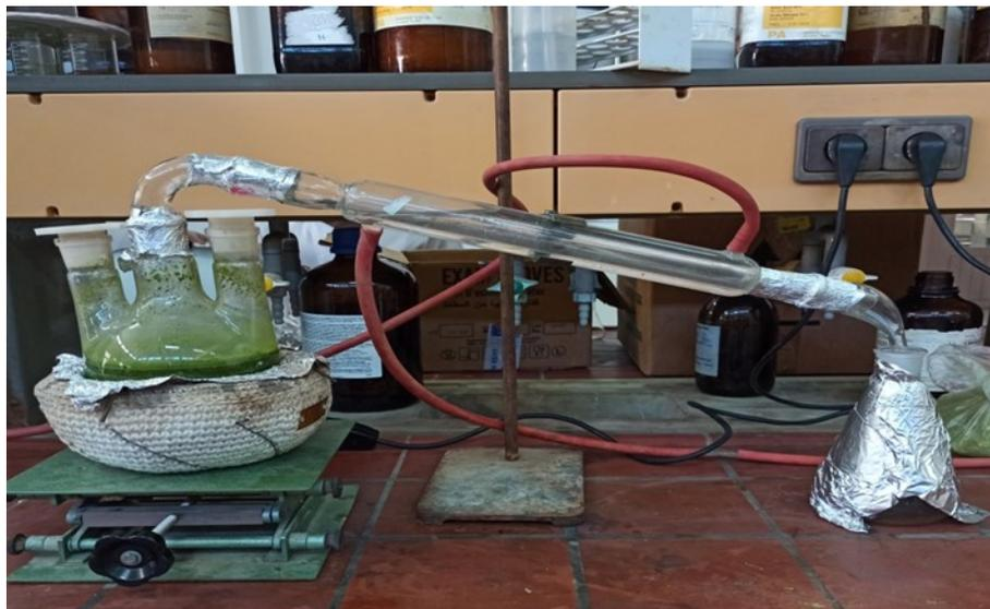
**Figure 5:** Montage d'hydro-distillation.
