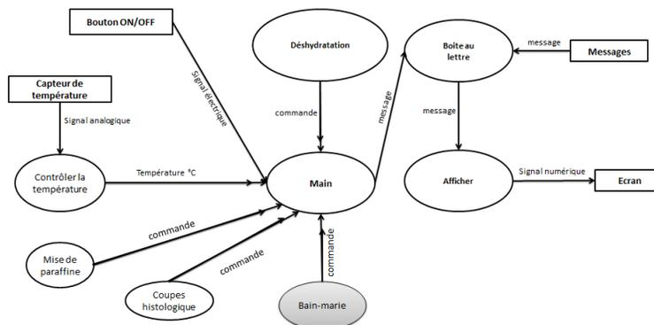
FIGURE 4.46 – Diagramme de flux de données "Etuve".
