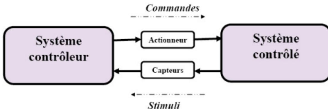
FIGURE 2.2 – : Principe général d'un système temps réel
