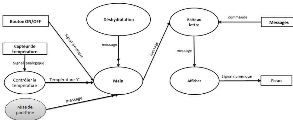
FIGURE 4.25 – Diagramme de flux de données "Paraffine".
