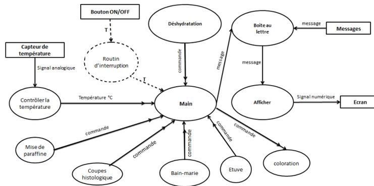
FIGURE 4.54 – Diagramme de flot de contrôle "Coloration".
