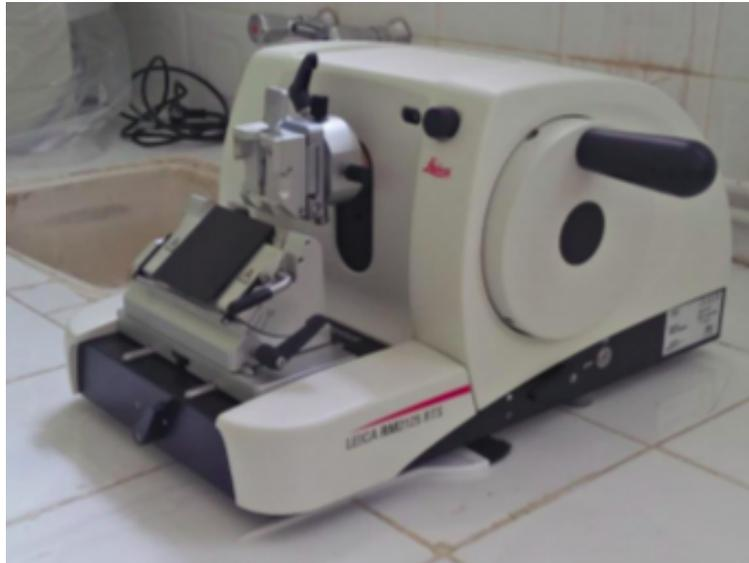
FIGURE 4.5 – Microtome rotatif de type LEICA 2125.
