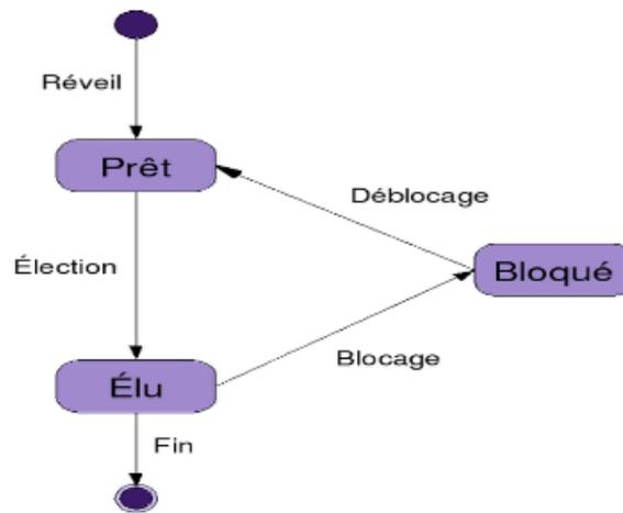
FIGURE 2.6 – Diagramme d'état d'un processus simple.
