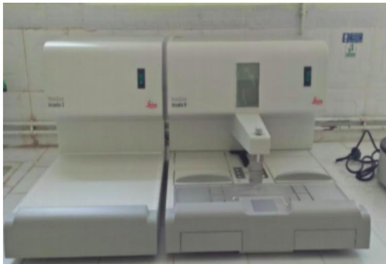
FIGURE 4.4 – Centre d'enrobage LEICA Arcadia C 2615 et Arcadia H 2224
