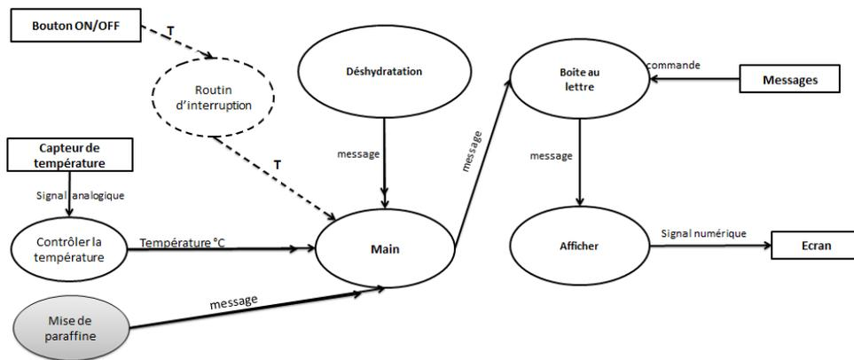
FIGURE 4.33 – Diagramme de flot de contrôle "Coupes histologique".
