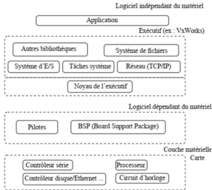
FIGURE 3.3 – Exemple d'un exécutif temps réel Vx Works.
