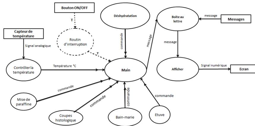
FIGURE 4.47 – Diagramme de flot de contrôle "Etuve".
