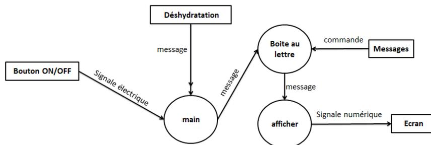
FIGURE 4.17 – Diagramme de flot de données "Déshydratation".
