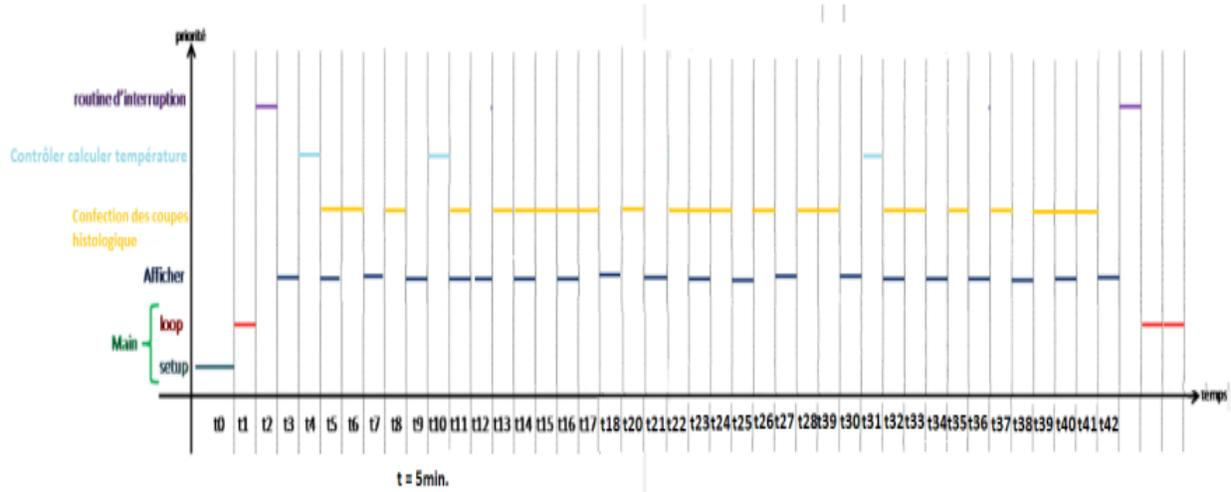
FIGURE 4.59 – Le chronogramme de la séquence d'exécution "Coloration".
