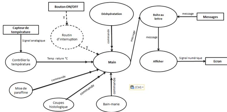
FIGURE 4.40 – Diagramme de flot de contrôle "Bain-marie".
