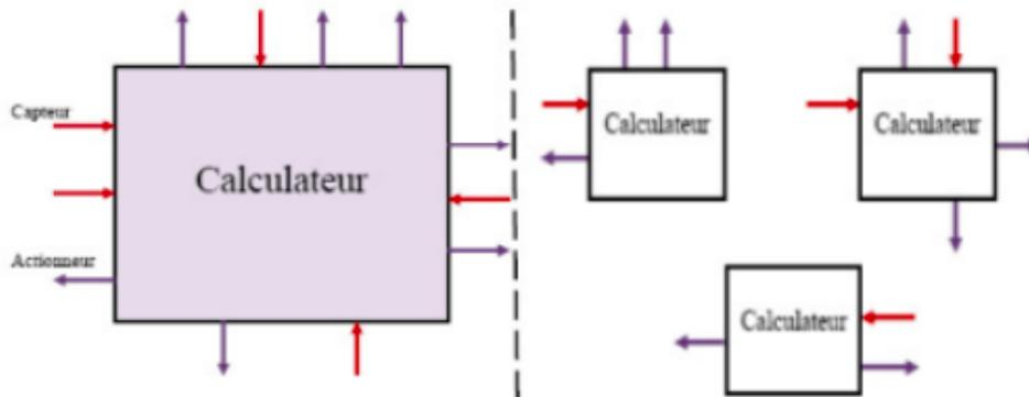
FIGURE 2.3 – Architectures centralisée et multi-calculateurs.
