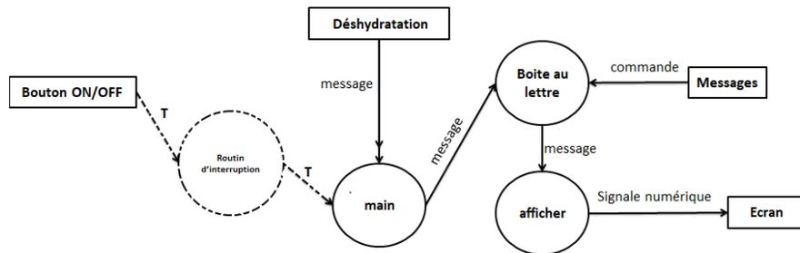
FIGURE 4.18 – Digramme de flot de contrôle "Déshydratation".
