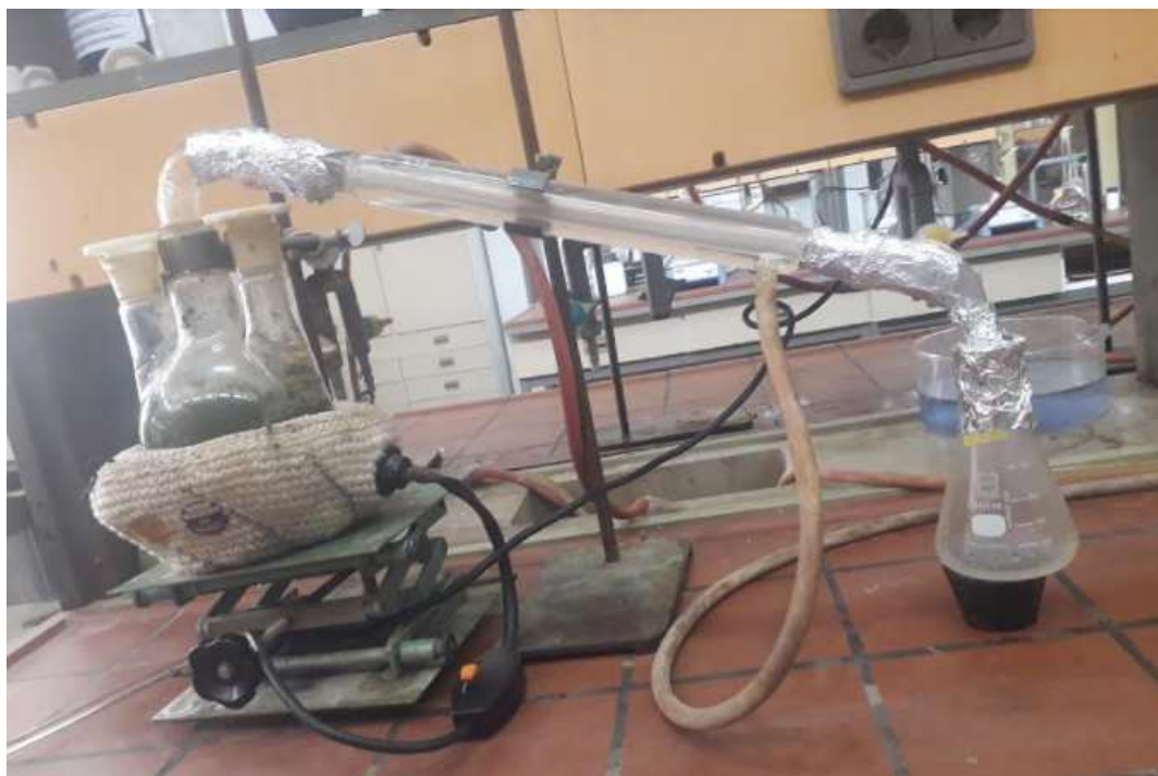
Figure 01: Montage expérimental de l'hydrodistillation
