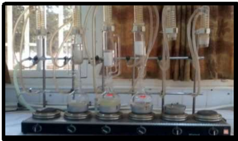
Figure 05 : Appareil (Soxhlet) utilisé pour l'extraction aux solvants volatils
