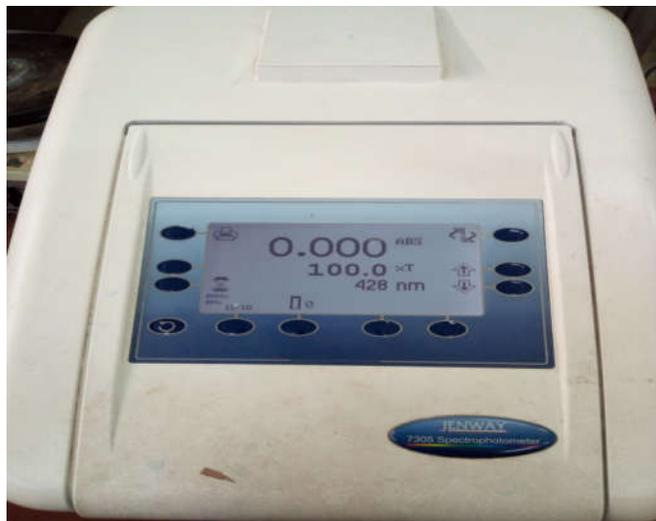
**Figure III-11 :** Spectrophotomètre UV-visible utilisé
