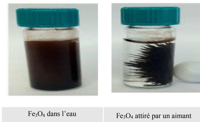
**Figure IV-6** : L'attraction des nanoparticules de Fe<sub>3</sub>O<sub>4</sub> par un aimant magnétique
