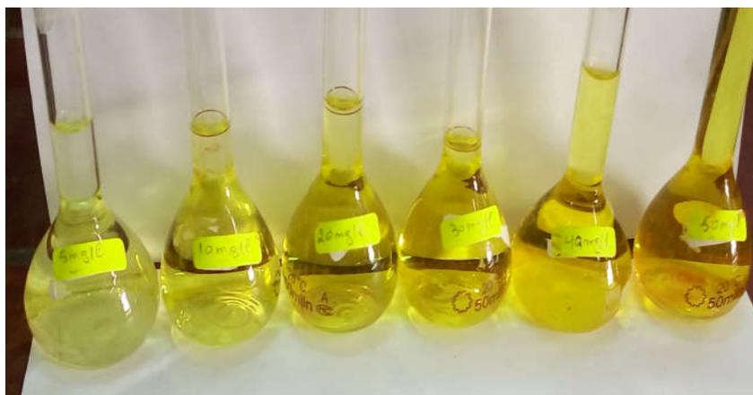
**Figure III-10 :** La série des solutions à différentes concentrations [5~ 50] mg/ L
