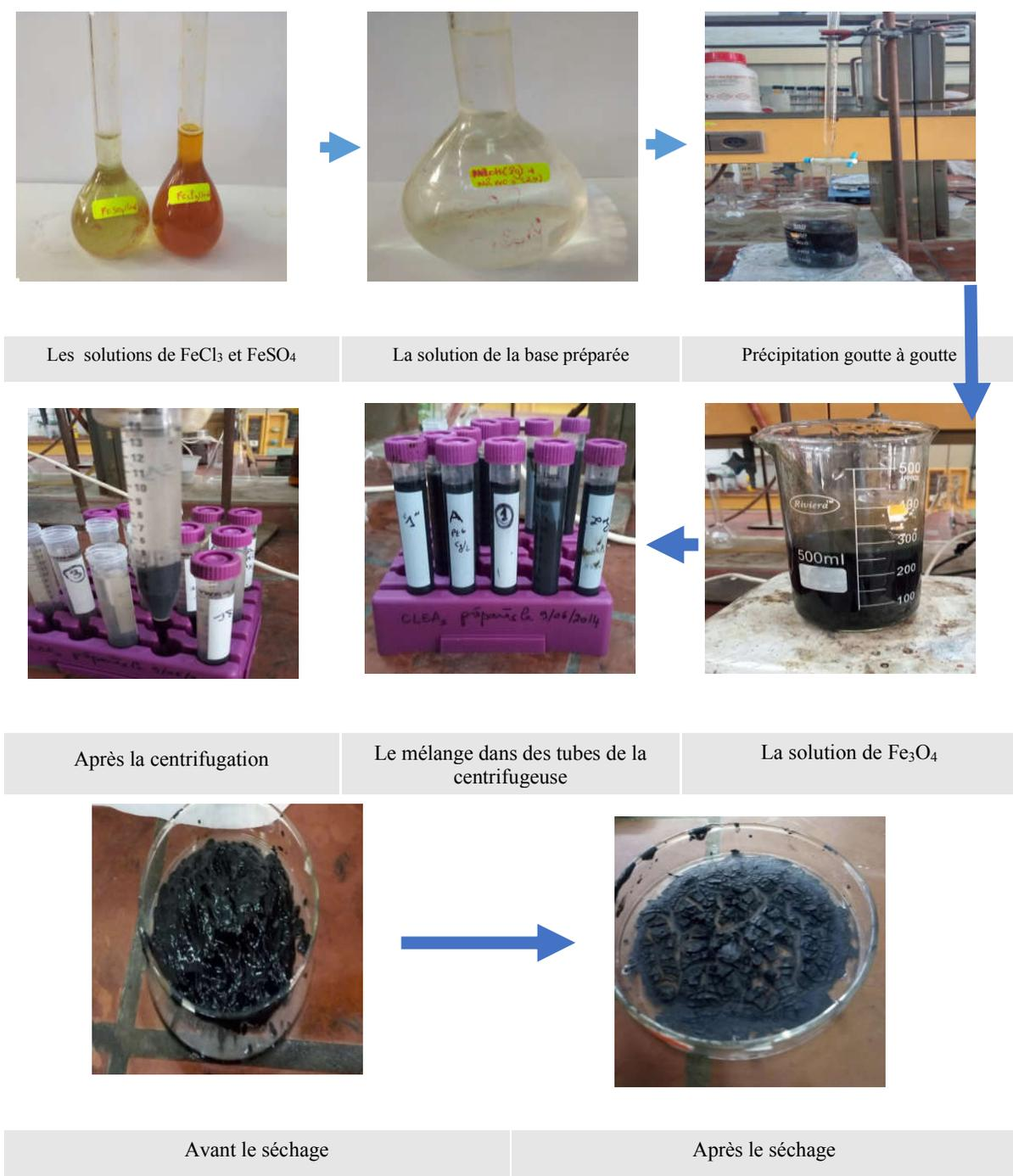
**Figure III-4 :** Préparation des nanoparticules de Fe<sub>3</sub>O<sub>4</sub>
