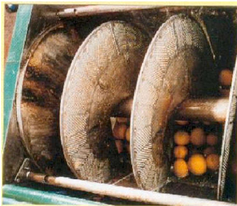
Figure 2: Extraction par l'expression à froid ( E. Bénéteaud, 2011 )
