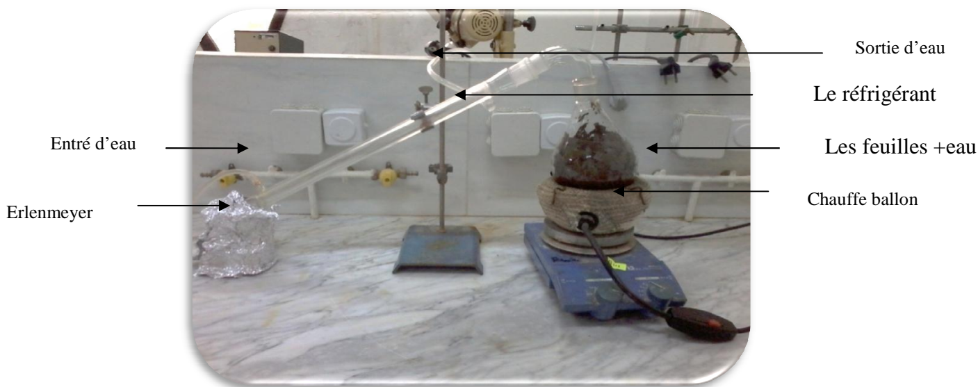
Figure n° 07: Photo du montage d'Hydro distillateur.
