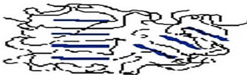
Figure II.4 : Structure d'un nano composite intercalé [13]
