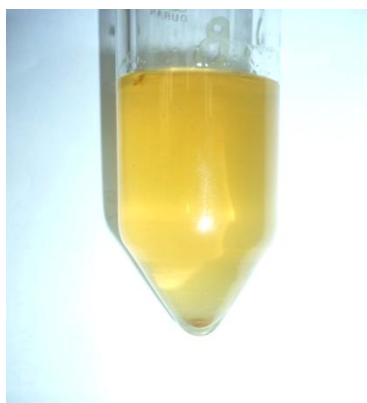
Figure 07: Formation du sédiment après centrifugation
