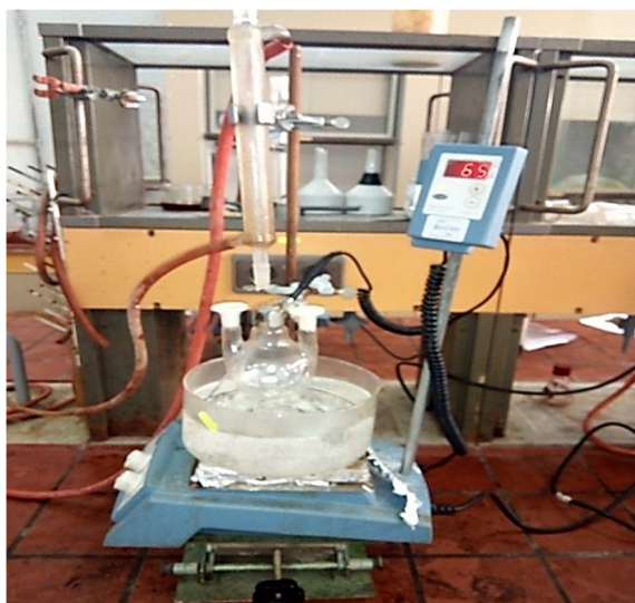
Figure II.1 : Le montage expérimental de la synthèse de polyacrylamide
