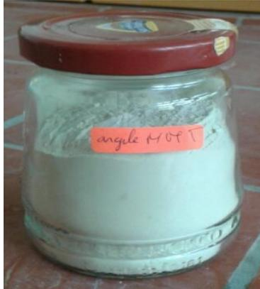
**Figure III.3 :** l'argile locale de Maghnia (la montmorillonite).
