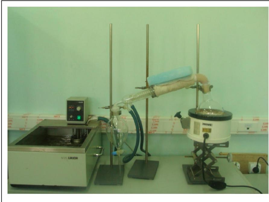
**Photo 01:** Dispositif d'hydro-distillation
