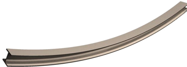
Figure II.6: Phénomène du déversement.
