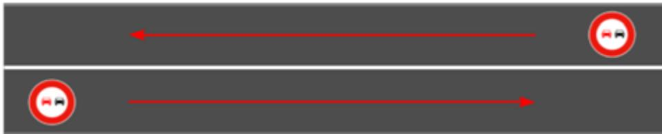
**Figure VII.5 :** Ligne continue interdisant le franchissement ou le chevauchement
