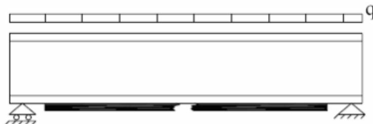
*Figure IV.4 : Rupture en tension de la plaque composite [30]*
