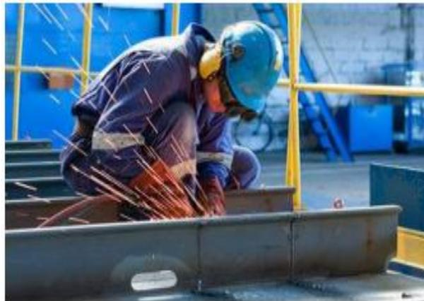
*Figure II.3 : Soudage à l'arc avec fil fourré [21].*
