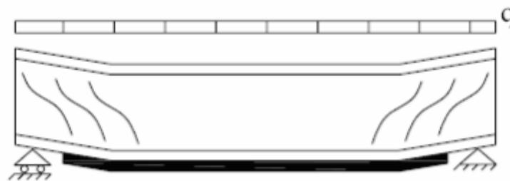
*Figure IV.7: Rupture en cisaillement [30].*
