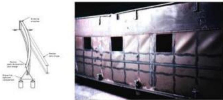
*Figure I.13: Phénomène de déversement des poutres [15].*
