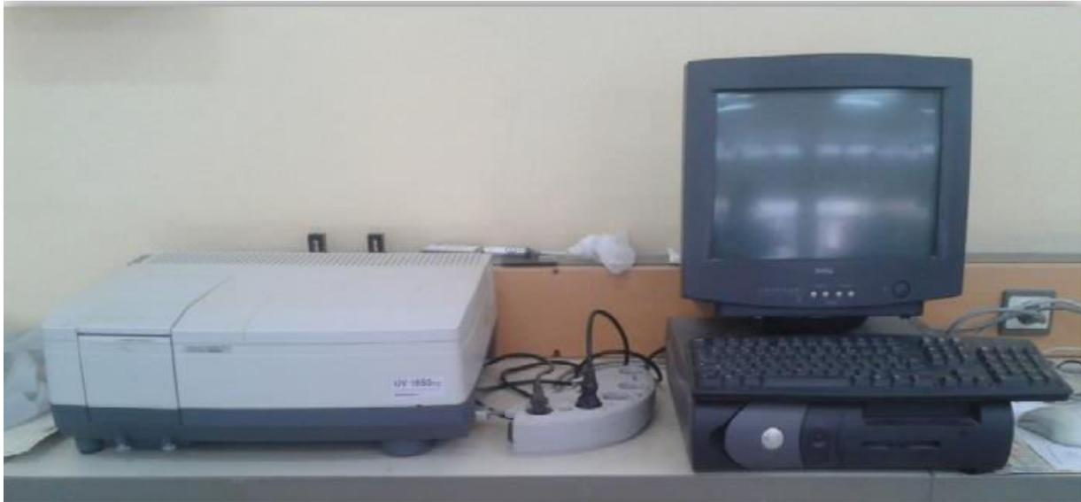
**Figure III.6** : Spectrophotomètre à double faisceau de type SHIMADZU(UV 1650 PC).
