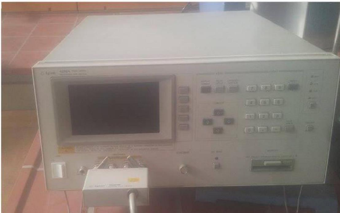
**Figure III.8 :** Impédance-mètre AGILENT 4285A.
