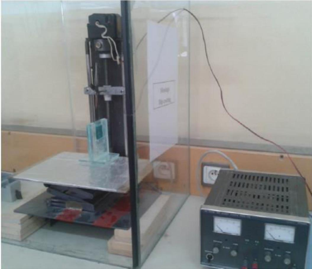
**Figure III.3:** Dispositif expérimental de trempage-tirage (dip-coating).
